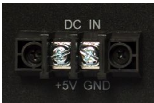
Рисунок 16 – Ввод 5В DC (устройство UniPing server solution v4/SMS и UniPing server solution v3/SMS )
